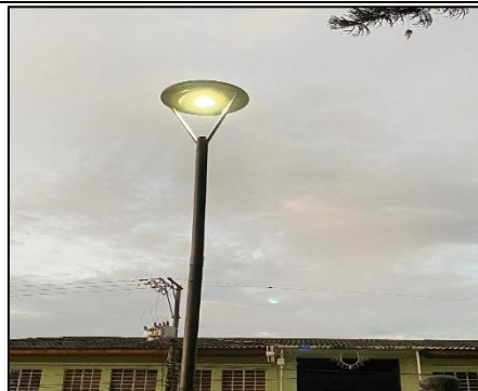
Luminarias del parque sin filtro antideslumbramiento
